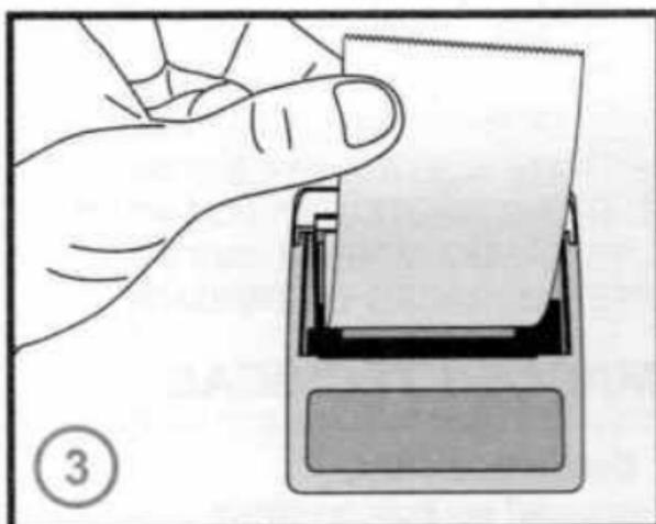
Coloque a nova bobina desenrolando-a para baixo, deixando sua ponta para fora do compartimento
